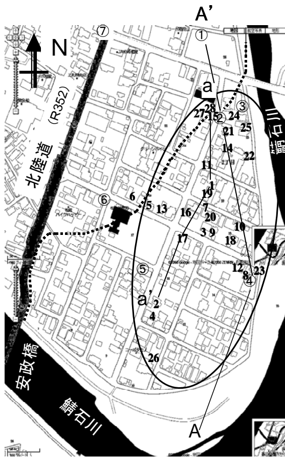
図 3. 2. 63 SWS 調査地点と液状化エリア
