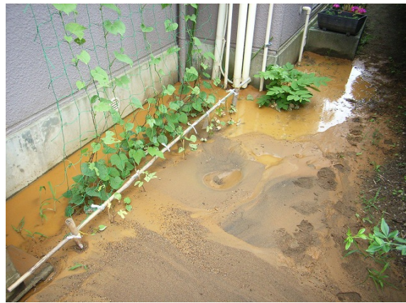
写真 3.2.70 最大余震時の家屋周りの噴砂 (撮影地点⑯)
