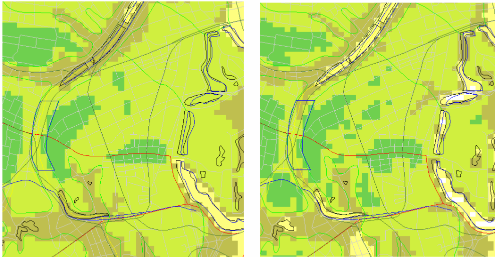
図 5-7 標高参照の比較（左：50mDEM，右：5mDEM による変換 50mDEM）
