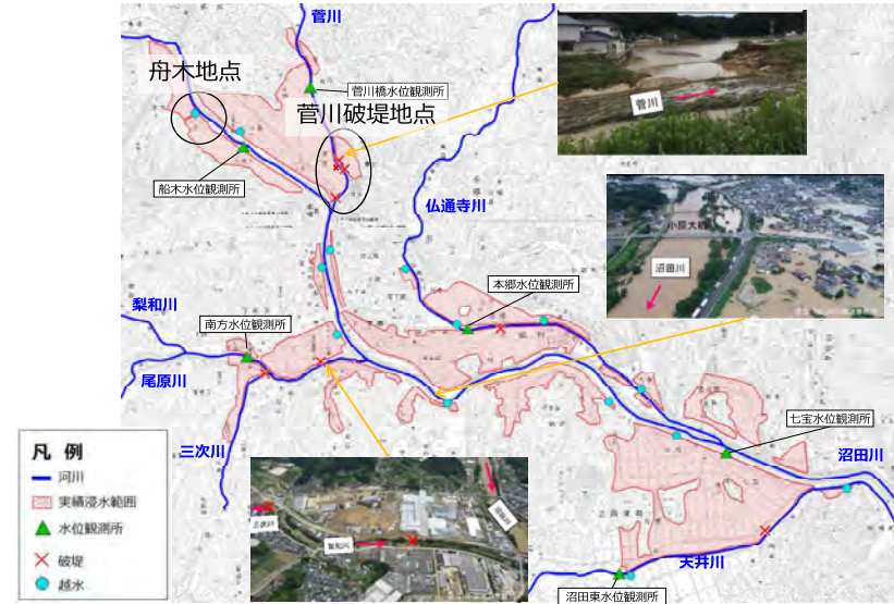
資料：広島県、平成30年7月豪雨災害を踏まえた今後の水害・土砂対策のあり方検討会 河川・ダム部会（第一回ワーキング資料）、破堤点（菅川右岸追加）、平成30年8月17日現在暫定結果
